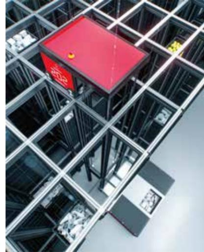
Im neuen „Autostore“ können 52.000 Lagerbehälter in sehr kompakter Form bevorratet werden. Der Clou dabei: Die Boxen werden nicht auf klassischen Regalflächen abgestellt, sondern in Stapeln mit bis zu 16 Stück Boxen übereinandergestellt werden. Gemanagt wird der Komplex durch 15 computergesteuerte Roboter im oberen Bereich.
