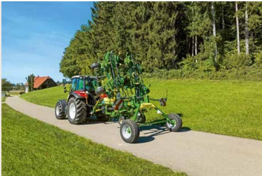
Mehr Bodenfreiheit: Das Fahrwerk des Vendro T 1020 sorgt für einen optimalen Straßentransport des Kreiselzettwenders.
