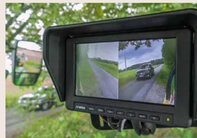
alle Verkehrssituationen problemlos auf dem geteilten Monitor einsehen und ist mit größtmöglicher Sicherheit unterwegs. Der vom Gesetzgeber geforderte Einweiser, z. B. bei engen Feld- oder Hofausfahrten, ist damit überflüssig. <<
